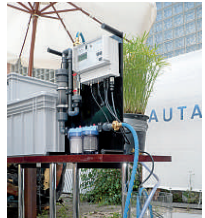
Sonnenschirm als Solarmodul-Ersatz: das SuMeWa-Wasserdesinfektionssystem, das im Auslieferungszustand die Größe einer Umzugskiste hat, im aufgebauten Zustand. Es hat keine Verschleißteile, kann von technisch Ungeschulten bedient werden und ist einfach zu reinigen.
